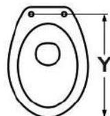
La distanza Y dal bordo anteriore al centro dei fori di fissaggio sul vaso in ceramica è di:
